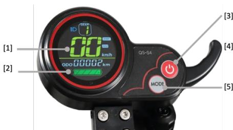
**Changement de vitesse.** Pour changer de vitesse(1=lent, 2=moyen, 3=rapide), lorsque la trottinette est en position ON, appuyez sur le bouton POWER pour entrer dans les réglages du mode de vitesse. Appuyez sur MODE pour modifier la vitesse. Pour revenir à l'écran principal, appuyer sur power et attendez deux secondes.
